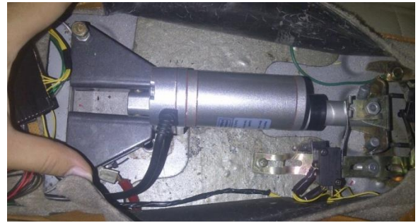
Gambar 12 Hasil Pemasangan Motor
