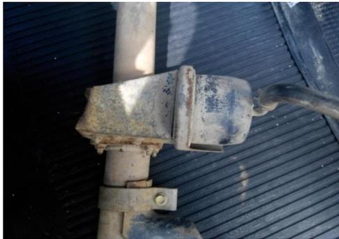
Gambar 6. Contoh *exhaust brake* Isuzu ELF
