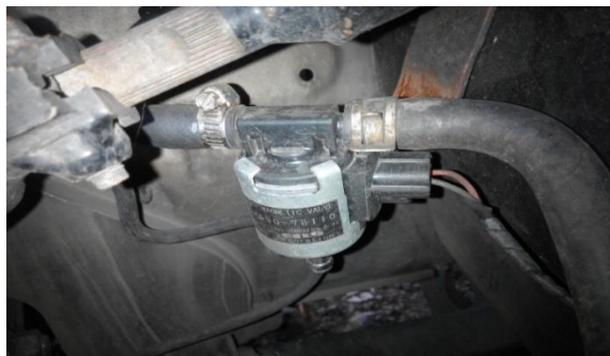
Gambar 14. Pemasangan Selenoid Vacuum
