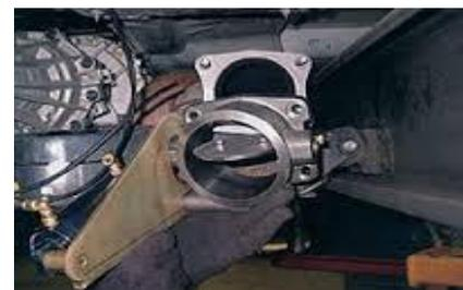
Gambar 1 *Exhaust brake* Pada Truk Colt Diesel
