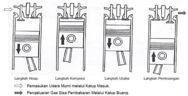
Gambar 2. Siklus Kerja Mesin Diesel
