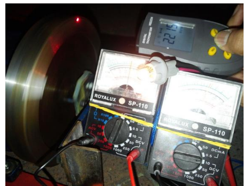
Gambar 8. Posisi takometer untuk pengujian
