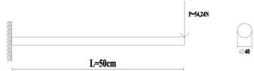
Gambar 46. Analisa gaya pada tuas Berikut tegangan tekuk yang terjadi pada tuas:
