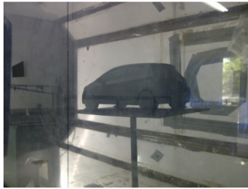
Gambar 4. Pengujian Drag Bodi Miniatur
