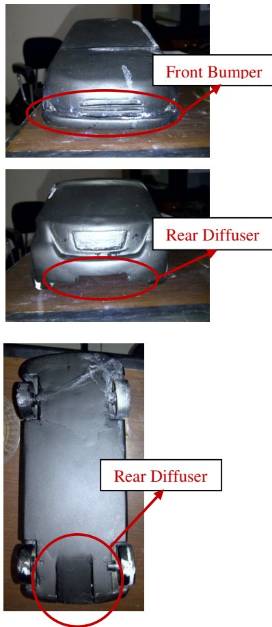
Gambar 6. Hasil Modifikasi Front Bumper Dan Rear Diffuser
