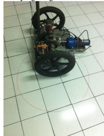
Gambar 12. Pengujian rem pada 1 roda.
