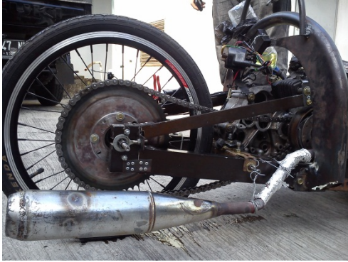
Gambar (4) Gear 55 gigi pada prototype .
