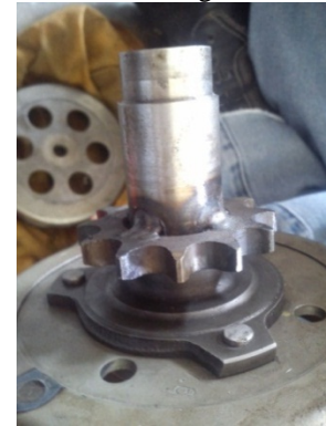
Gambar (2) Gear 12 gigi.
