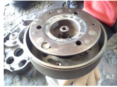
Gambar (1) Kopling tipe basah menjadi tipe kering
