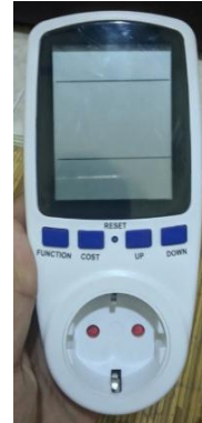
Gambar 14. KWh Meter Digital Pemandang
