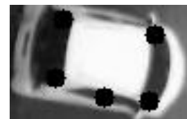
Gambar 1. Corner detection pada suatu image.
