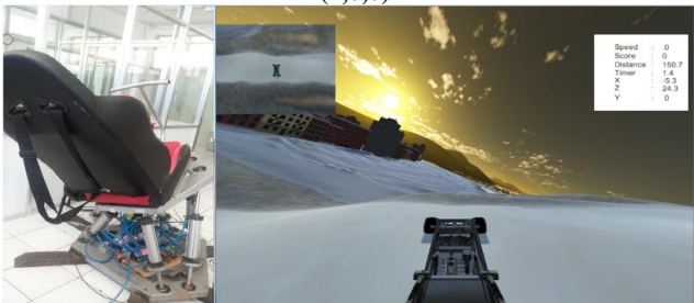
Gambar 10. Gerakkan Diskrit Hexapod dengan dengan input (0,1,0)
