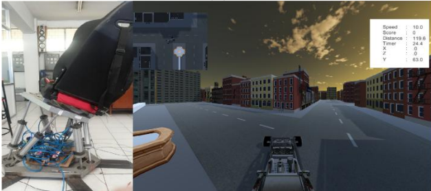
Gambar 8. Gerakkan Diskrit Hexapod dengan dengan input (0,0,1)
