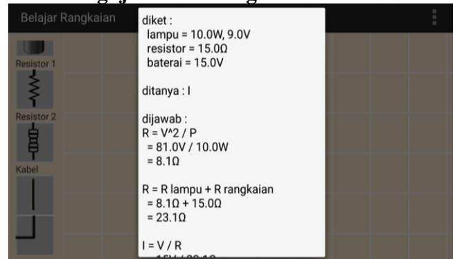
Gambar 8. Pengujian Kuat Arus Seri
