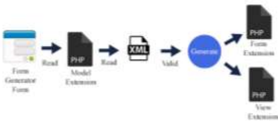
Gambar 8. Ilustrasi cara kerja form generator
