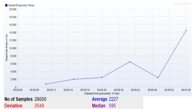
**Gambar 7.** Average response time dan deviation keseluruhan *scenario* pada sistem *scalable microservices*
