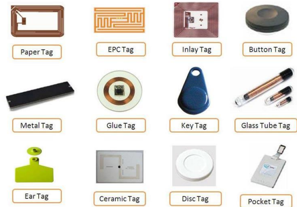
Gambar 2. Bentuk Tag RFID [4]
