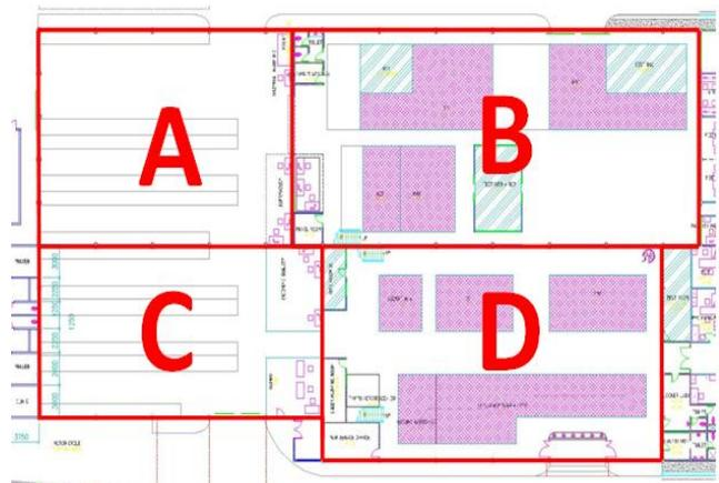
**Gambar 1.** Pemetaan lokasi *smoke detector* di lantai produksi
