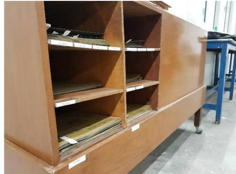
**Gambar 7** Penempatan amplas setelah penerapan 5S
