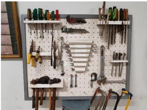
Gambar 2. Penyimpanan peralatan dan perkakas setelah penerapan 5S
