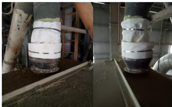
Gambar 6. Usulan Penerapan Pemasangan Kain Ayakan
