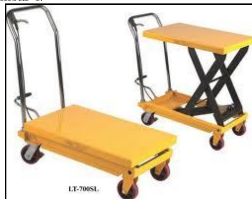
Gambar 4. Alat Bantu ( scissor lift ) Untuk Packaging Paku Besar
