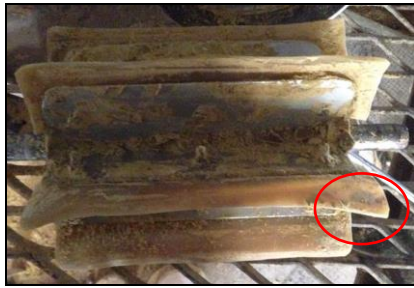
Gambar 4. Kondisi kipas airlock
