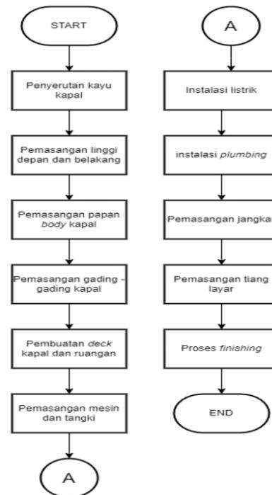
Gambar 2. Alur Proses Produksi Kapal
