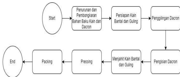
Gambar 3. Alur produksi bantal dan guling
