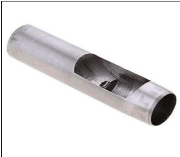
Gambar 1. Alat plong yang dipakai
