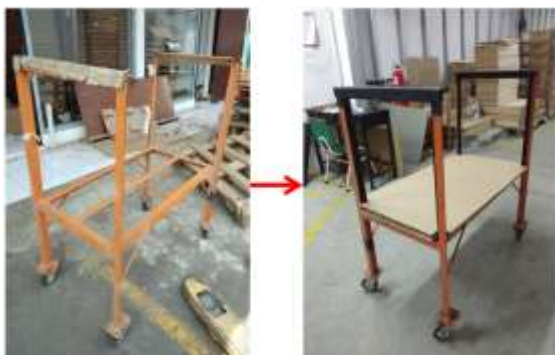
Gambar 5. Kondisi kereta besi sebelum dan setelah penerapan usulan media pengaman.
