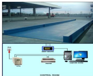
Gambar 23. Jembatan timbang dihubungkan dengan sistem
