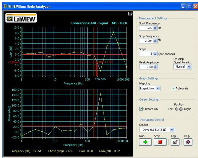
Gambar. 22. Hasil Pengujian frekuensi respon pada -3\text{dB} \pm 180\text{Hz} .
