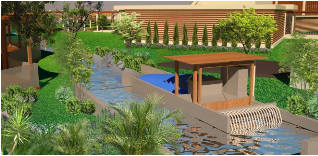
Gambar. 2.13 Peletakan hyrdoturbine pada bangunan. Sumber: penulis
