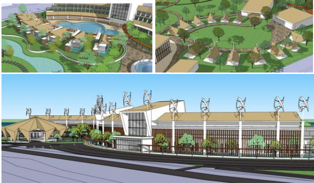
Gambar. 2.17 Peletakan wind turbine pada bangunan. Sumber: penulis.
