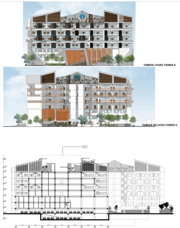
Gambar 2. 8. Tampak dan potongan keseluruhan bangunan
