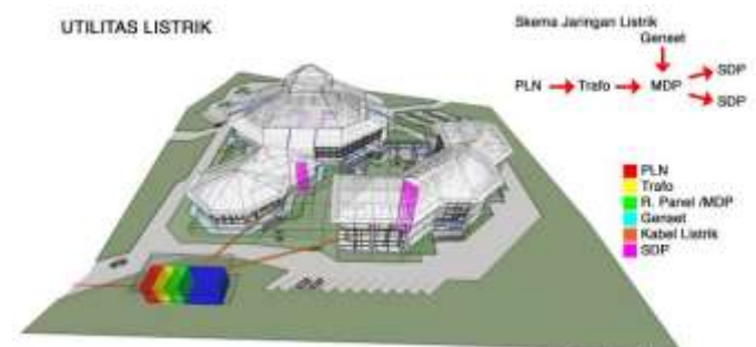
Gambar 2. 28. Skema Utilitas Listrik
