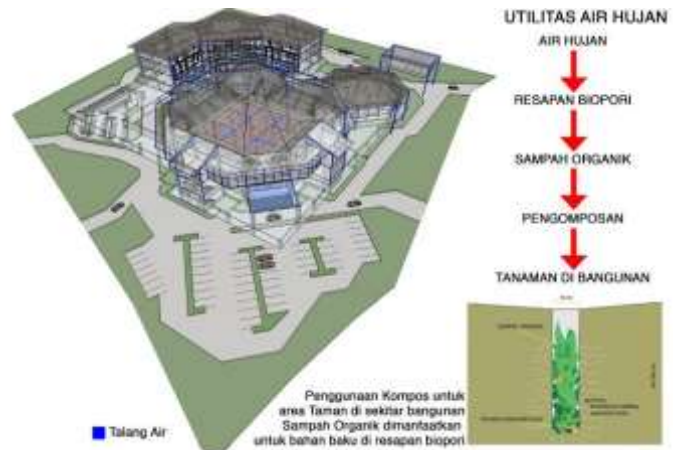
Gambar 2. 26. Skema utilitas air hujan
