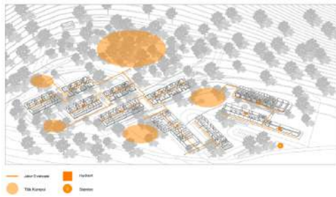
Gambar 5.4. Sistem Utilitas Evakuasi dan Kebakaran
