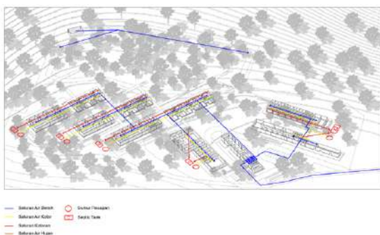
Gambar 5.1. Sistem Utilitas Air
