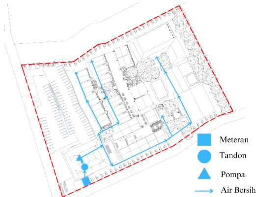
Gambar 5.1. Utilitas Air Bersih
