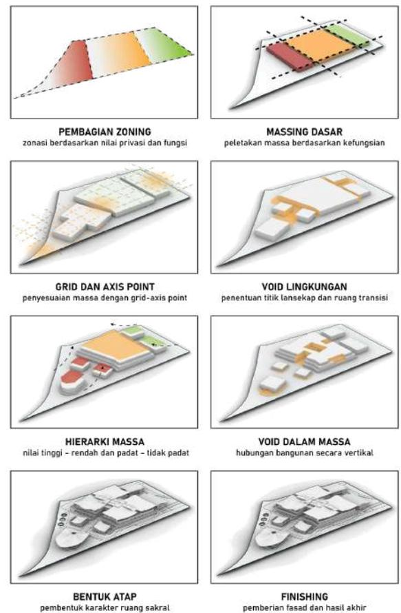
Gambar 2.5 Diagram Transformasi Bentuk
