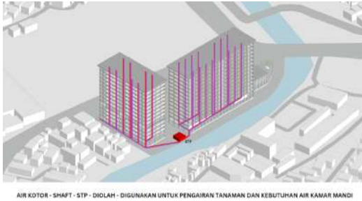
Gambar 5.2. Sistem Utilitas Air Kotor dan Kotoran
