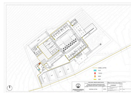
Gambar 5.5. Sistem Utilitas Listrik
