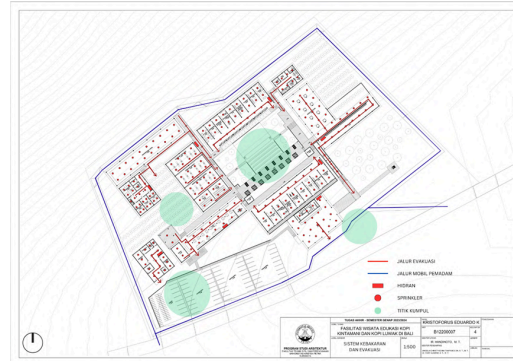
Gambar 5.4. Sistem Utilitas Kebakaran dan Jalur Evakuasi
