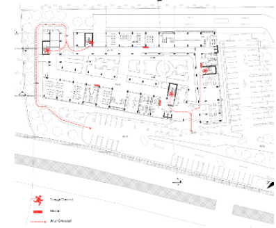
Gambar 5.10. Utilitas Kebakaran dan Evakuasi pada Layout Plan
