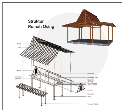
Gambar 4.1. Sistem struktur Rumah Osing
