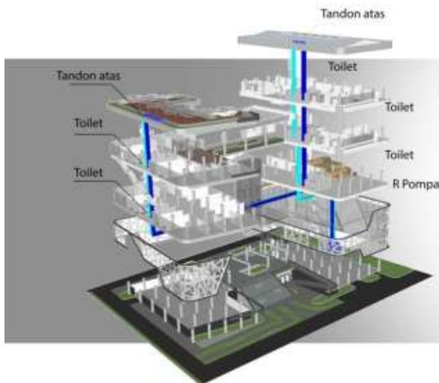
Gambar 6.1. Isometri sistem air bersih
