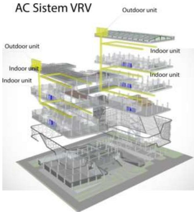
Gambar 6.2. Isometri sistem tata udara
