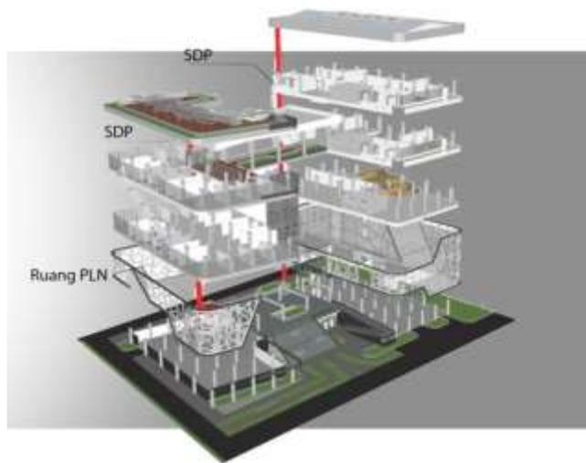
Gambar 6.3. Isometri sistem listrik
