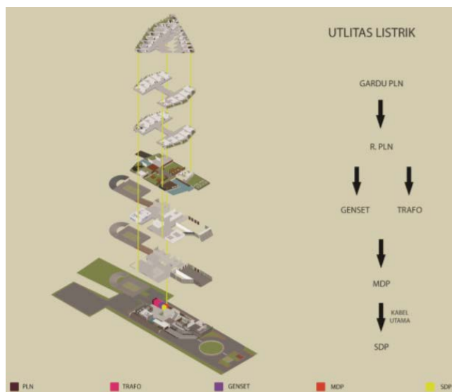
Gambar 1. 28. Sistem utilitas listrik
