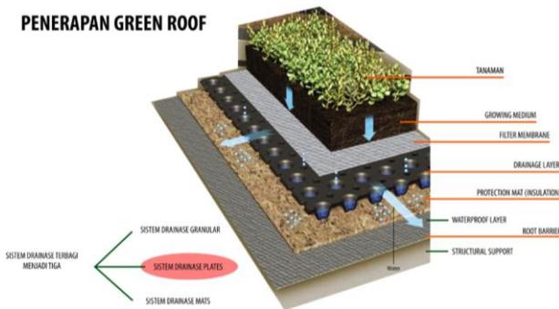
Gambar 2.21 Sistem drainase *plates* yang digunakan pada bangunan. Sumber: Google Images.
