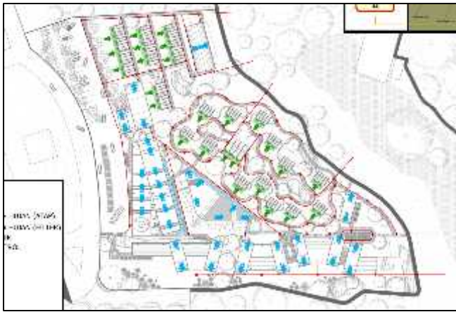
Gambar 2.14 Sistem Utilitas (air hujan).
