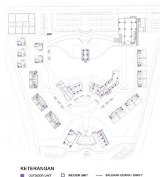
Gambar. 2.27 Diagram sistem penghawaan aktif
