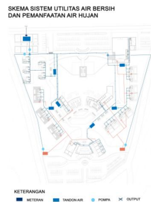
Gambar. 2.24 Diagram sistem air bersih
