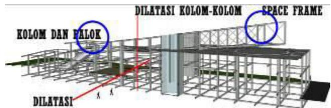
Gambar 2.15 Sistem space frame dan letak dilatasi. Sumber: penulis
