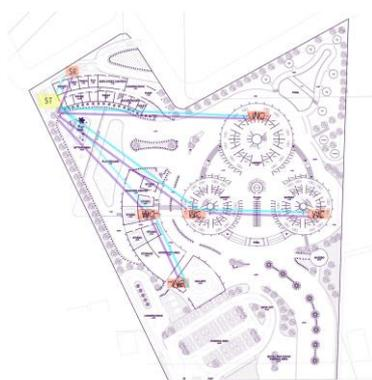
Gambar 2.17 Sistem sanitasi air kotor dan kotoran. Sumber: penulis
