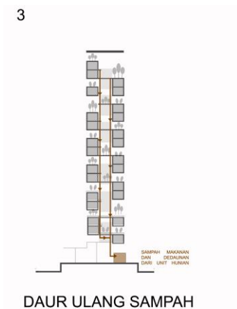
Gambar 2.17. Diagram sistem daur ulang sampah.
