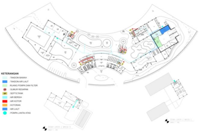
Gambar 2.16 Sistem Utilitas (sanitasi).
