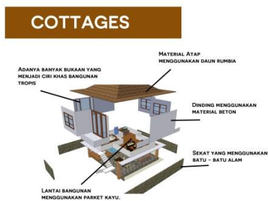
Gambar 2.18 Denah dan Aksonometri material cottages. Sumber: penulis
