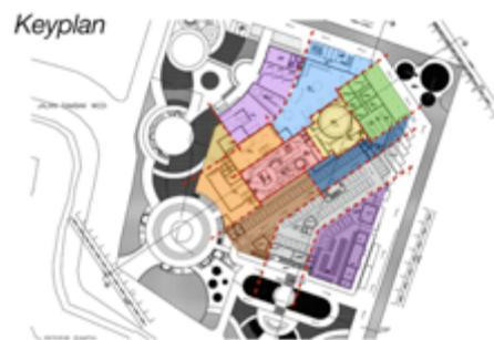
Gambar. 2.21 Keyplan pemutusan struktur
