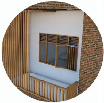
Gambar 2.22 Perspektif unit hunian dengsn area jemur yang diberi kisi-kisi dan jendela dengan shading kayu.
