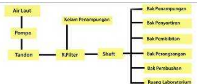
Gambar 2.28 Skema distribusi air laut. Sumber: penulis
