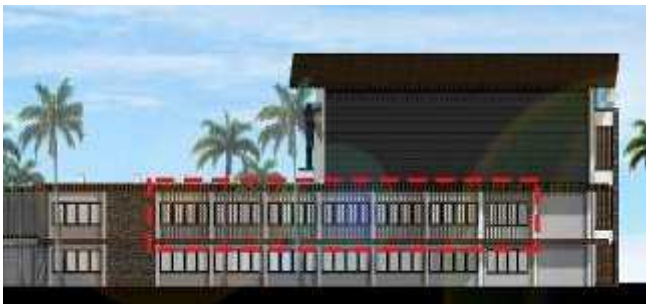
Gambar. 2.14 Menyediakan tempat untuk outdoor unit AC VRV pada eksterior Kelas. Sumber: penulis
