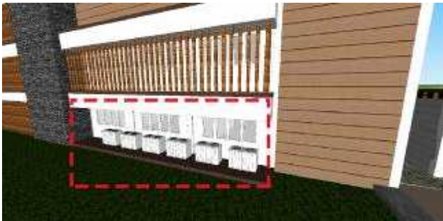
Gambar. 2.13 Menyediakan tempat untuk outdoor unit AC VRV pada eksterior Laboratorium. Sumber: penulis
