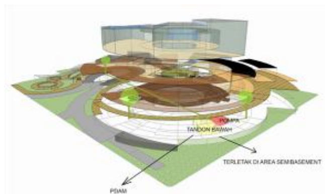
Gambar 2.14 Sistem Utilitas (air bersih)
