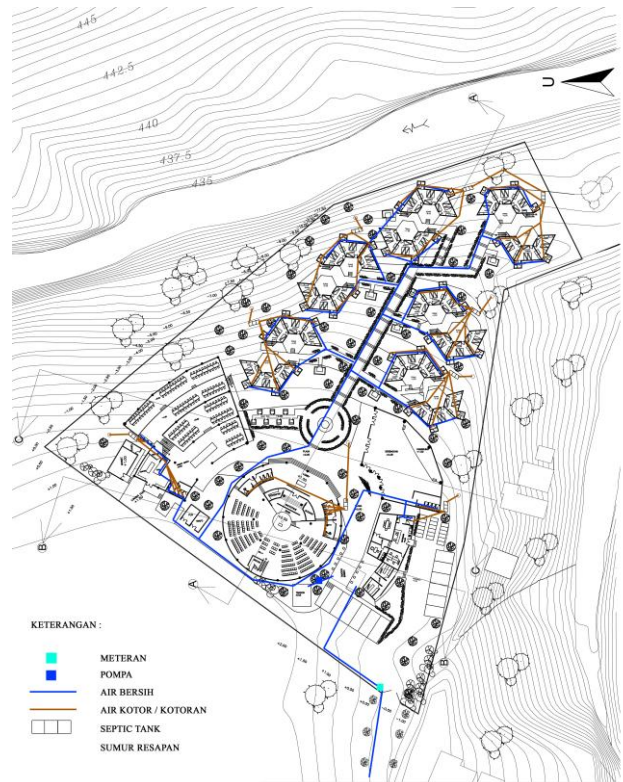
Gambar 2.17 Sistem Utilitas (sanitasi). Sumber: penulis
